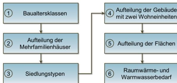
**Abbildung 8-1:** Schritte zur Erstellung des Gebäudemodells
